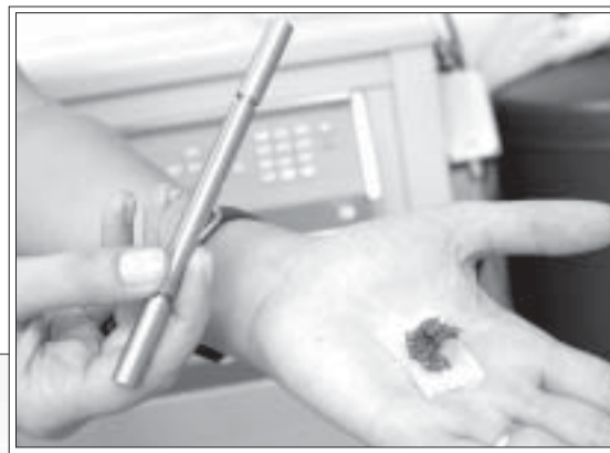
O professor Sérgio Gama (abaixo), coordenador do Grupo de Preparação e Caracterização de Materiais (GPCM) e, no destaque, o composto manganês-arsênio e a célula de pressão em forma de caneta
