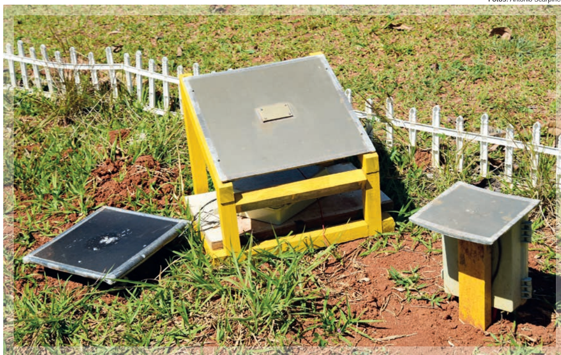
Sensor em teste em área da FEEC: modelo mais caro tem custo de US$ 2, contra US$ 200 dos dispositivos encontrados no mercado
