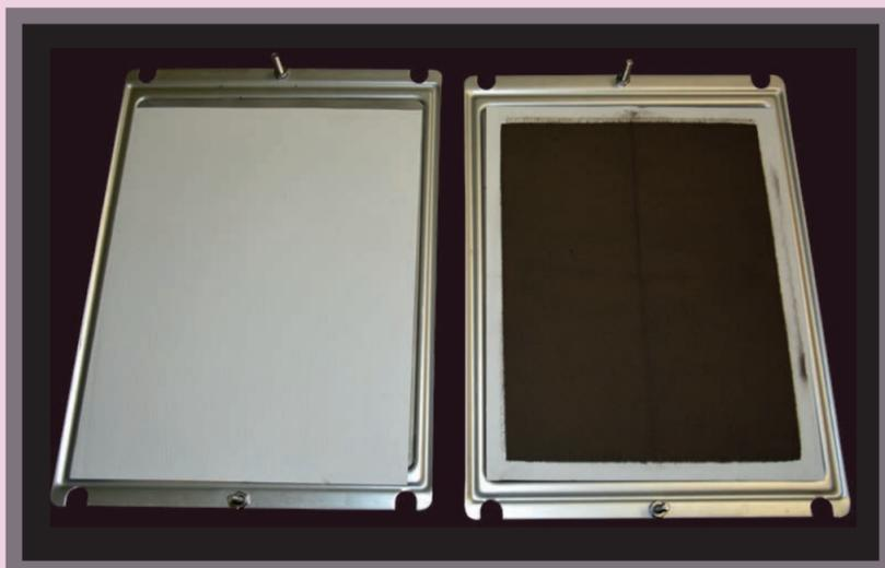
Filtros de ar, antes e depois da coleta de ar: em 24 horas, equipamento acumula uma quantidade de sujeira suficiente para deixá-lo preto e até entupi-lo
