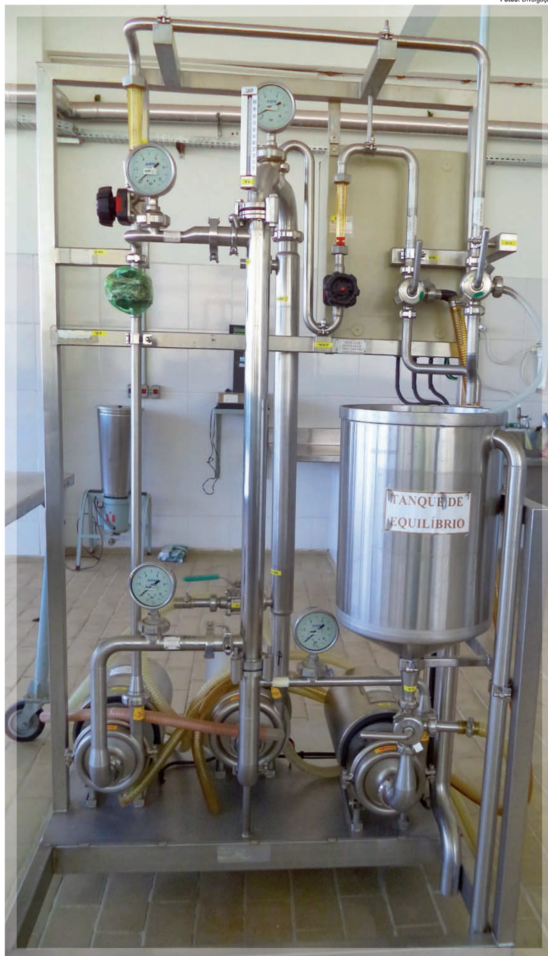
Equipamento usado nos testes: leite passa pelo processo de microfiltração
