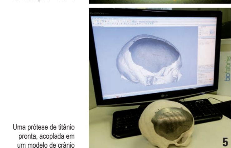
Um laser aplicado em pó de uma liga de titânio dá a forma definitiva à prótese sob medida fabricada pelo Biofabris
