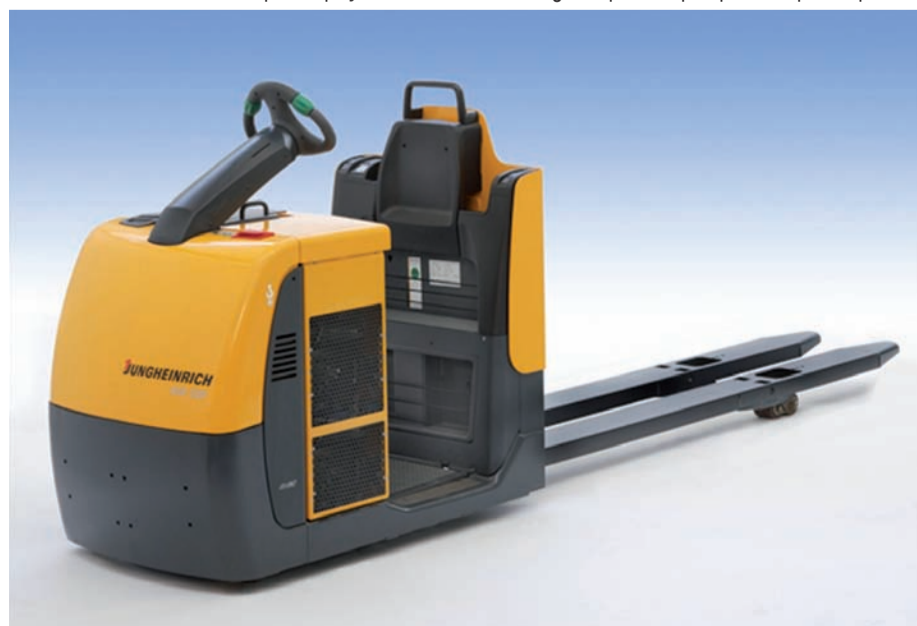
Empilhadeira movida a pilha combustível (à esq.) e um dos modelos de PEMFC: preocupação com fontes de energia limpa abre perspectivas para o produto
