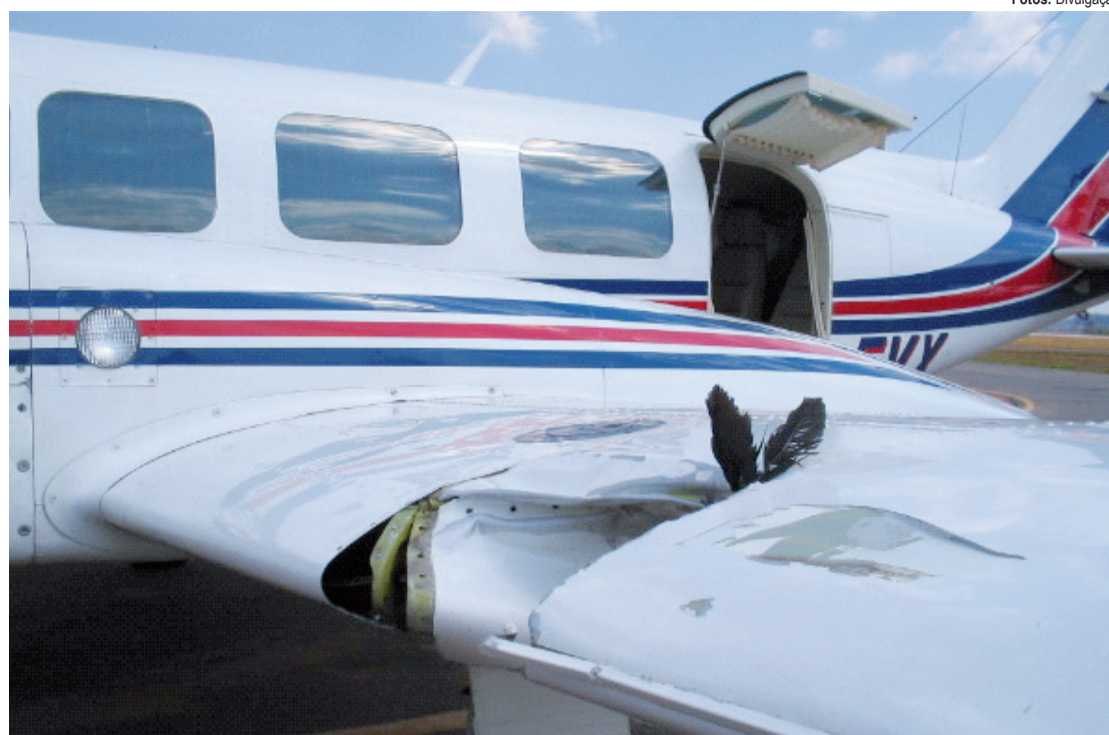
Asa de avião avariada depois de choque com ave: de 2006 a 2010, ocorreram 2,33 colisões a cada 10 mil movimentos no Brasil
