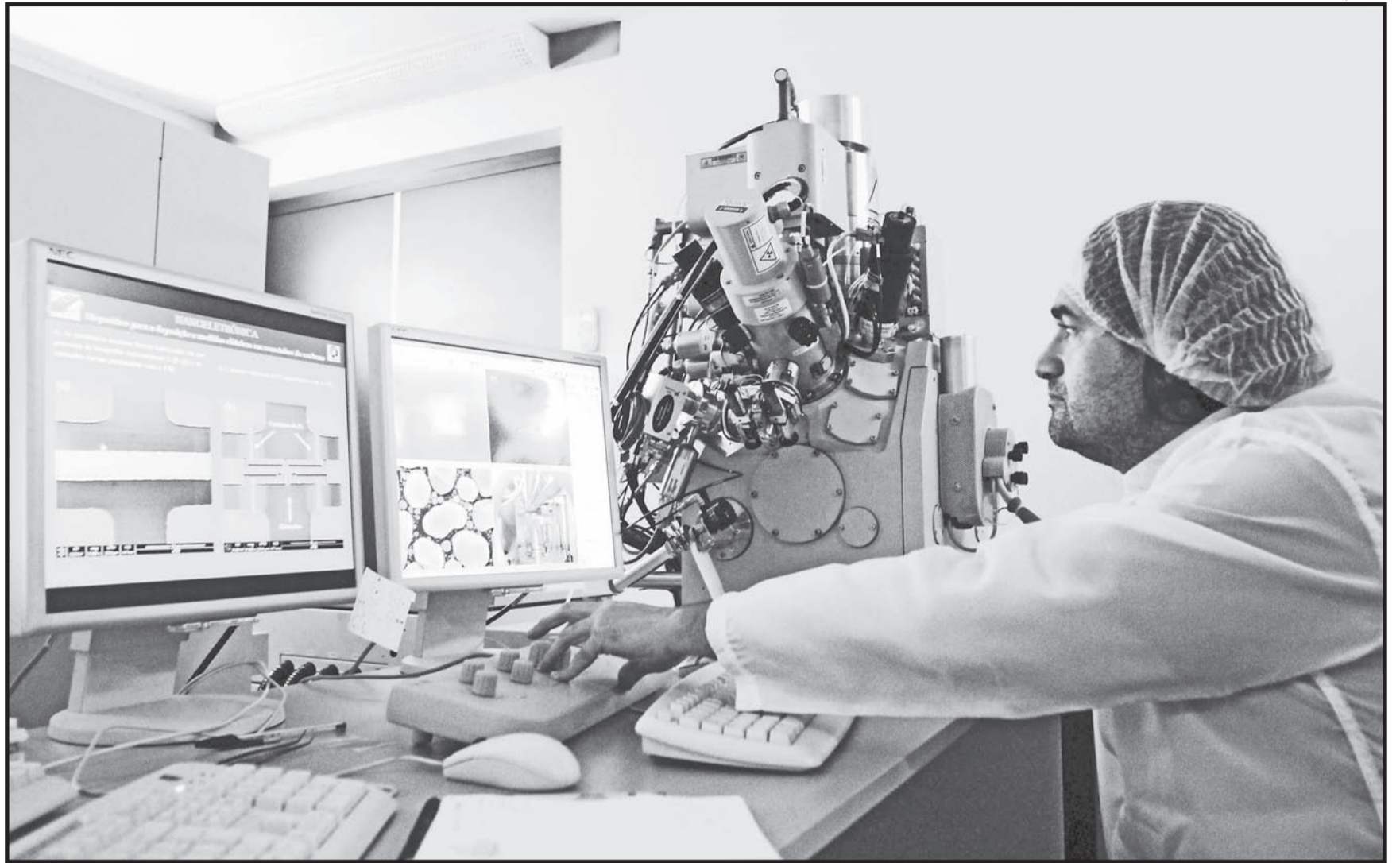
Sistema de feixe focalizado de íons (FIB-Focused Ion Beam), instalado no Centro de Componentes Semicondutores (CCS) da Unicamp e adquirido no âmbito do Programa Equipamentos Multiusuários da Fapesp, que está sendo avaliado pelo Geopi
