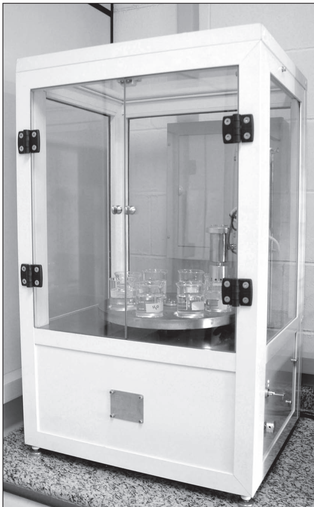
A máquina para a fabricação de filmes nanoestruturados: ferramenta fundamental para as pesquisas e para a produção de filmes multicamadas
