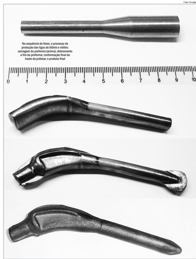
Na sequência de fotos, o processo de produção das ligas de titânio e nióbio: usinagem da preforma (acima); dobramento a frio da preforma; conformação final da haste da prótese; e produto final
