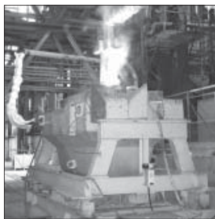
A tocha de plasma em funcionamento na siderúrgica Villares Metals: otimização da produção
