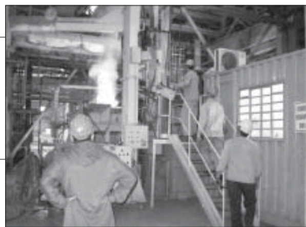
A tocha de plasma em funcionamento na siderúrgica Villares Metals: otimização da produção
