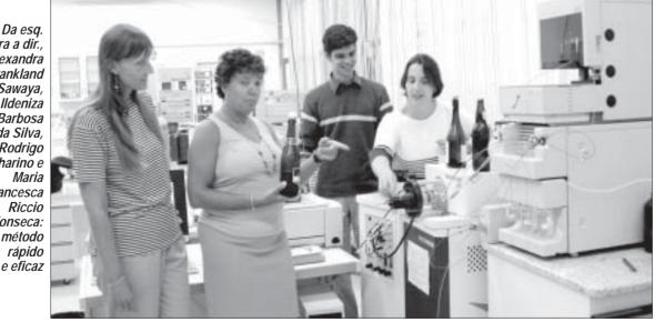
injetamos a amostra in natura na máquina. É como se nós embebedássemos o equipamento", brinca. Em seguida, o espectrômetro de massas analisa a bebida e aponta se há alguma substância estranha na mesma, tendo como referência uma amostra
