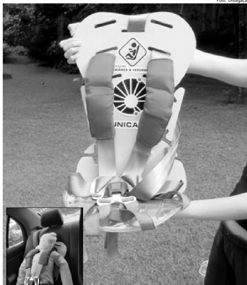
Detalhes do dispositivo desenvolvido na FEM: cintos adicionais de retenção garantem segurança em impacto a 50 km/h no campo de provas
