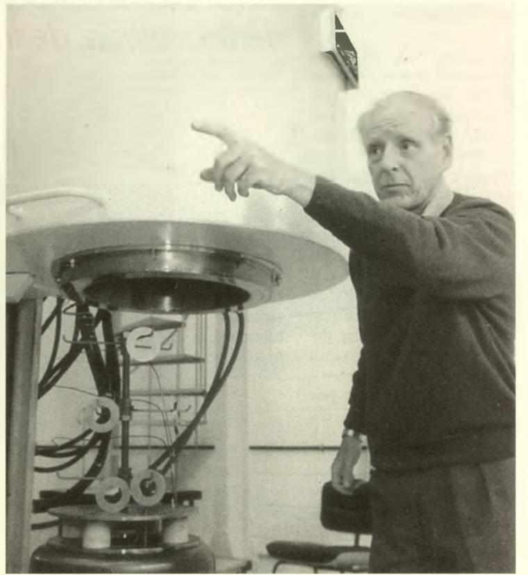
superfície dos metais com íons de nitrogênio. Os íons implantados e difundidos termicamente são incorporados à estrutura dos metais, alterando diversas das suas propriedades, tais como dureza, resistência ao impacto, atrito e corrosão, em função dos diversos parâmetros controlados do processo: composição e pressão dos gases, duração e frequência dos pulsos, intensidade de corrente, etc.
