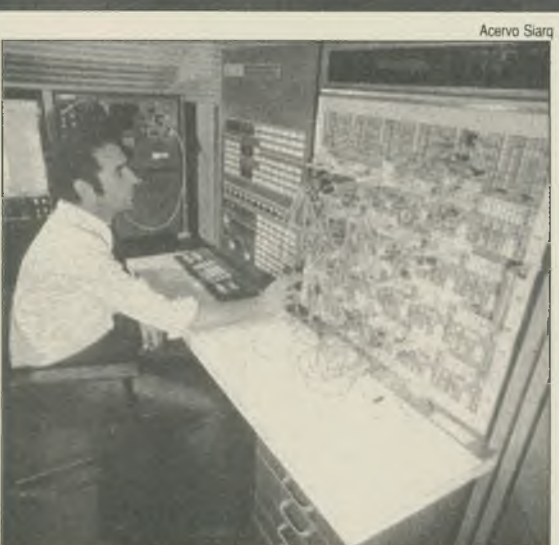
A tecnologia brasileira - Computador híbrido montado pelo Departamento de Engenharia Elétrica da Faculdade de Engenharia, em 1974. O projeto para se construir o primeiro computador eletrônico da América Latina, com tecnologia brasileira, desenvolve-se a partir de março de 1971.
