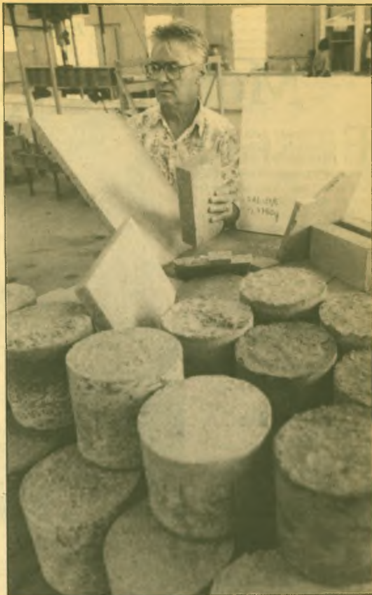
Amostras de produtos de pó de serra preparadas pelo pesquisador Luiz Cottini, da Faculdade de Engenharia Civil: parceria.
