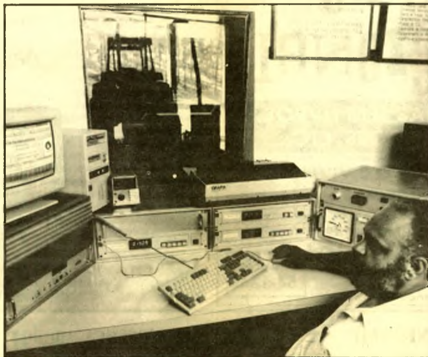
Nelson Cappelli, gerente operacional: medição de potência e consumo do trator.
