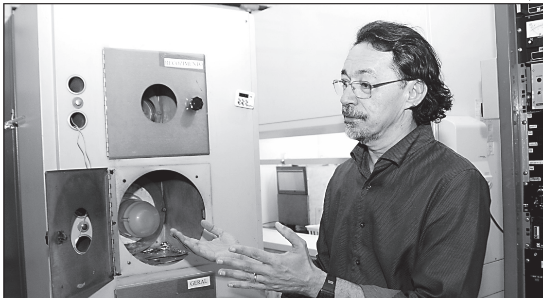
O professor Francisco Marques ao lado do forno para difusão de fósforo, no IFGW, onde é feita a fabricação das células solares
