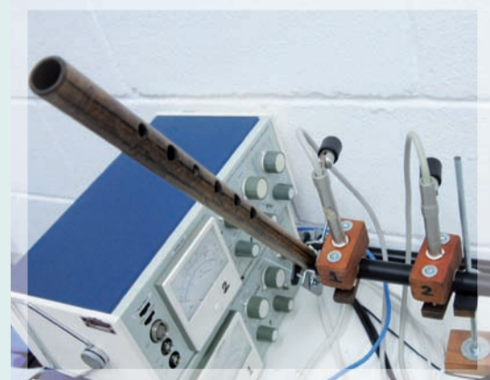
Pífano em laboratório: construção e validação de um medidor de impedância para sistemas tubulares
